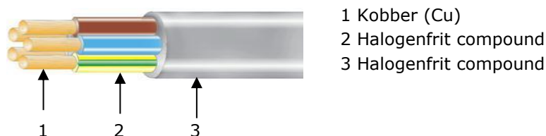
Figur 8: Geometrisk kabelopbygning med materialeangivelser
